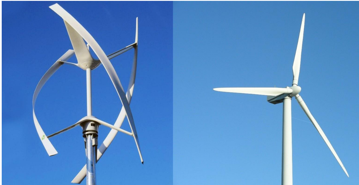
شکل ۲ - ظاهر توربین بادی با محور افقی (سمت راست) و توربین بادی با محور عمودی (سمت چپ)
