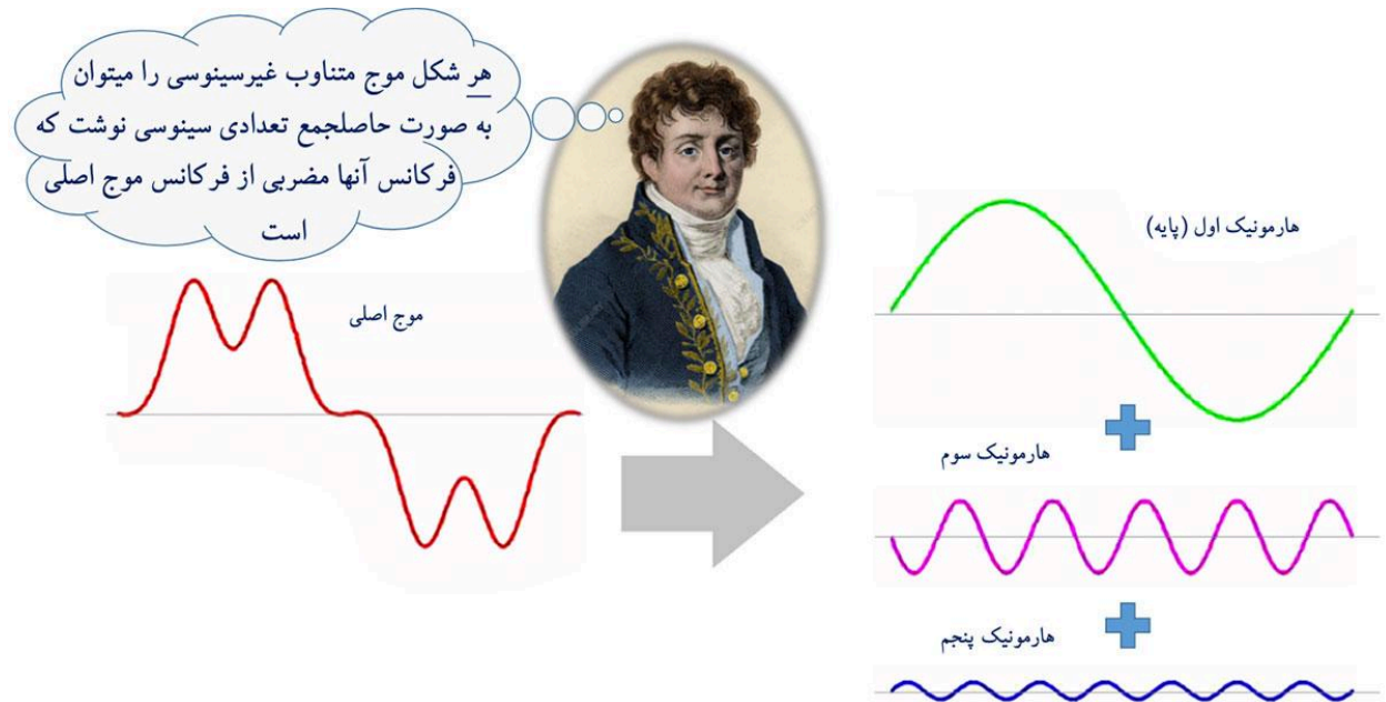
شکل ۵- تحلیل سیگنال متناوب غیرسینوسی با استفاده از تبدیل فوریه
